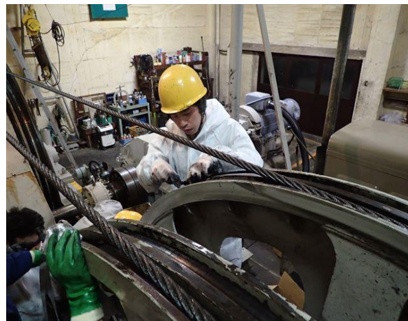
対動滑車ゴムブロックライナー交換作業
